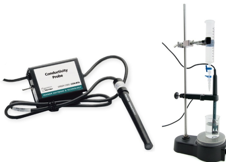
Abb. 1: Für Versuche zur elektrischen Leitfähigkeit eignet sich besonders der Leitwertsensor mit 3 umschaltbaren Messbereichen, für Titrations- und kinetische Experimente empfiehlt sich die Rührstation samt Tropfenzähler.
