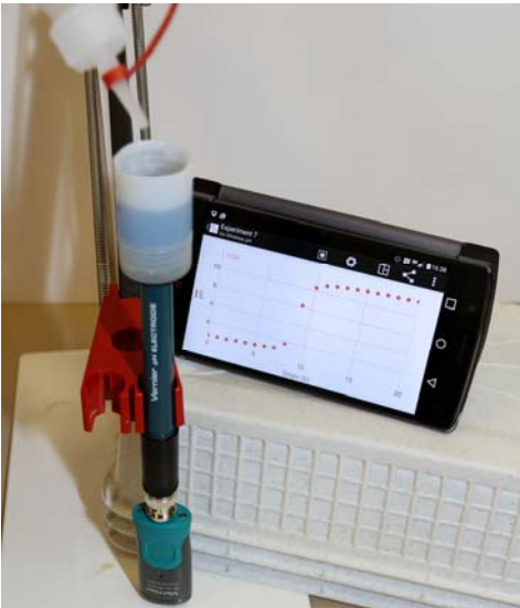
Abb. 5: Mikrotitration mit kabelloser Handy - Anzeige
