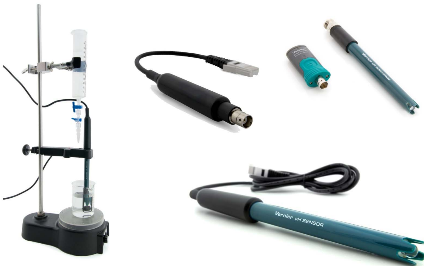
Abb. 1: Vernier pH-Sensor zum Anschluss an LabQuest und GoLink (rechts unten), Vernier BNC-Elektrode samt Go Wireless Elektrodenverstärker (rechts oben) und der normale Elektrodenverstärker für beliebige BNC-Elektroden (oben Mitte). Für Titrations und kinetische Experimente empfiehlt sich die Rührstation samt Tropfenzähler (links).
